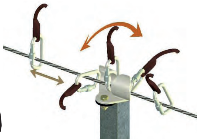
Exemples d'ancres structurelles intermédiaires.
