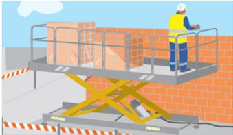
Le montage d'un mur en briques/parpaings expose à des risques de chutes de hauteur et à des risques liés aux manutentions manuelles et postures contraignantes
